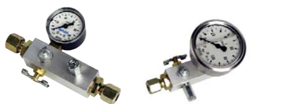
Visuele controleblokken voor montage in vetleidingen, inclusief smeernippel, manometer en overdrukbeveiliging.
